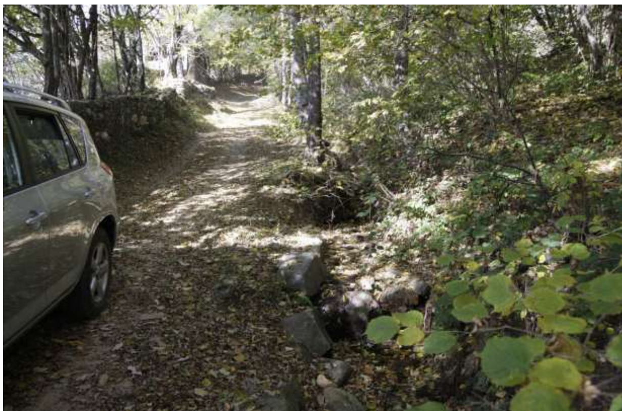
Illustrazione 2: tratto iniziale a monte con erosione della sponda lato strada
